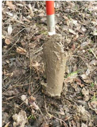
Photo 5 : Vue d'un carottage réalisé à la tarière
