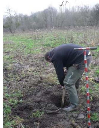
Photo 6 : Exemple de réalisation d'un sondage pédologique
